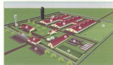
Рис. 19. Устройство животноводческой фермы: А — помещения для животных; Б — ветеринарная служба; В — выгульные площадки; Г — кормодец; Д — весовая; Е — кормильца сена; Ж — кормильца для коров (баран); З — силосная траншея; И — кормильца коров; К — навес (трава) для сельскохозяйственной техники; Л — водонапорная башня; М — санитарный пропускник и помещения для персонала; Н — площадка для отдыха персонала; О — служебная стена
