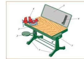
Рис. 9 Универсальный верстак: 1 — основание; 2 — поворачивающееся сиденье; 3 — стол (крышка); 4 — тиски; 5 — защитная сетка; 6 — подставка для технической документации; 7 — столярный зажим
