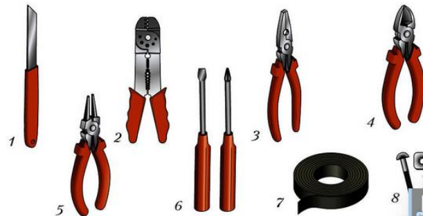
Рис. 34. Электромонтажные инструменты, материалы и крепёжные изделия: 1 — монтажный нож; приспособление для снятия изоляции; 2 — плоскогубцы; 3 — кусачки-бокорезы; 4 — круглогубцы; 5 — плоскогубцы; 6 — плоскогубцы; 7 — изоляционная лента; 8 — крепёжные изделия
