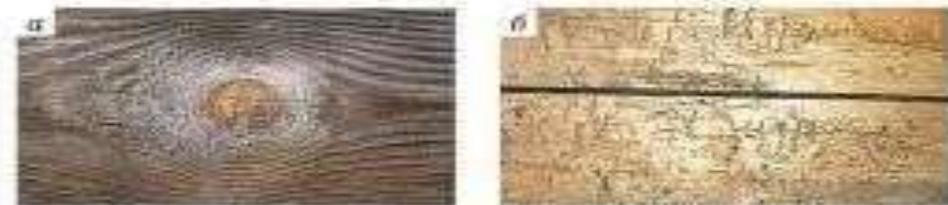
Рис. 2.7. Недостатки древесины: а — сучок; б — червоточина и трещина
