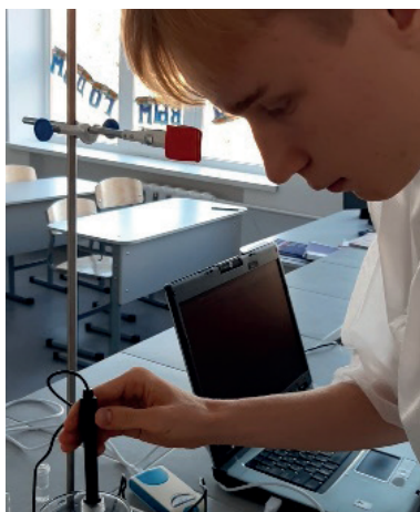
Рис. 1. Определение среды раствора датчиком рН цифровой лаборатории
